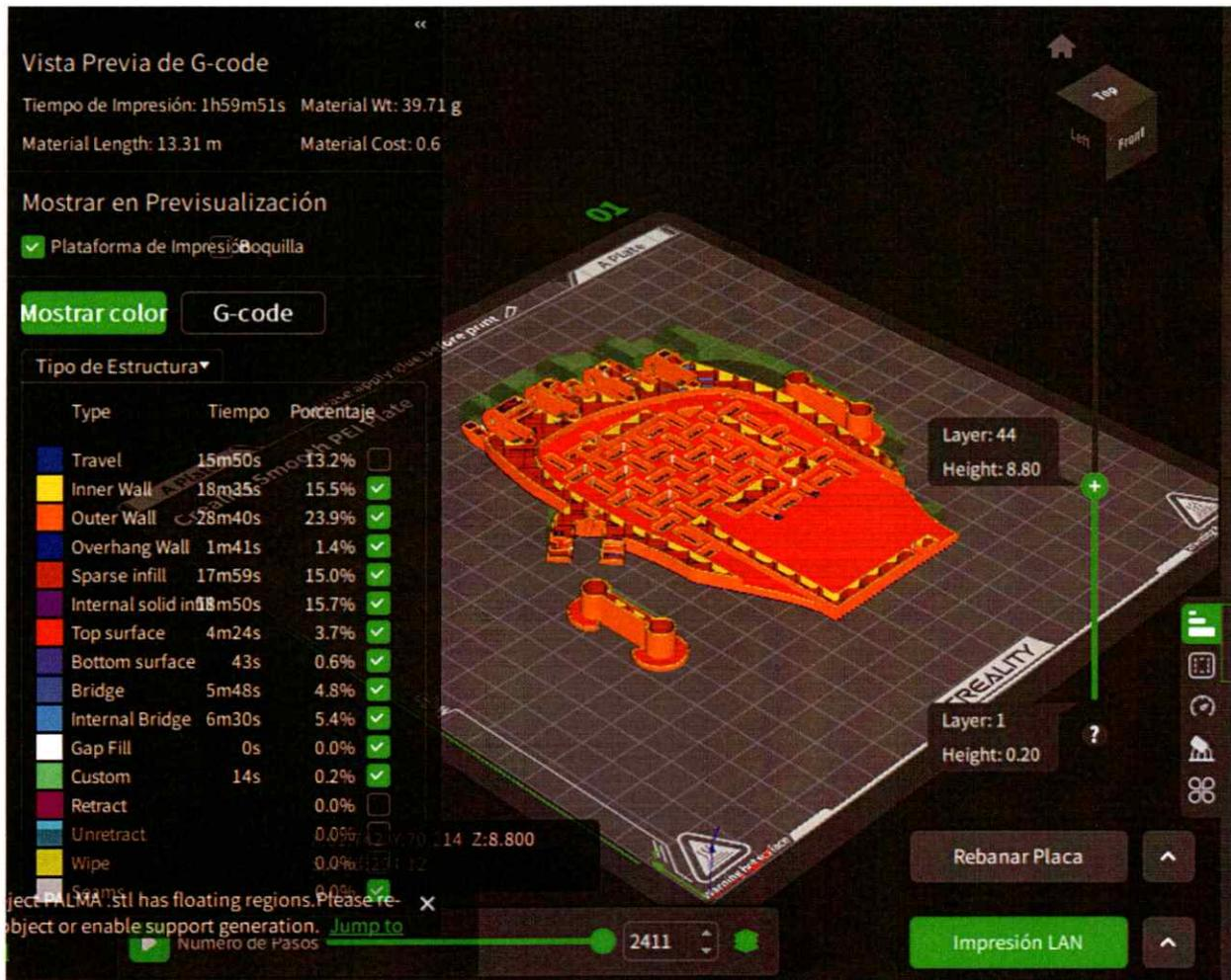
Figura 28. Impresión 3D Palma - conectores de movimiento por capas en Crality Print 5.1. Fuente: Los Autores.
