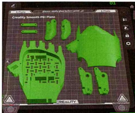
Figura 7. Posicionamiento de piezas en en Crality Print 5.1. Fuente: Los Autores.
