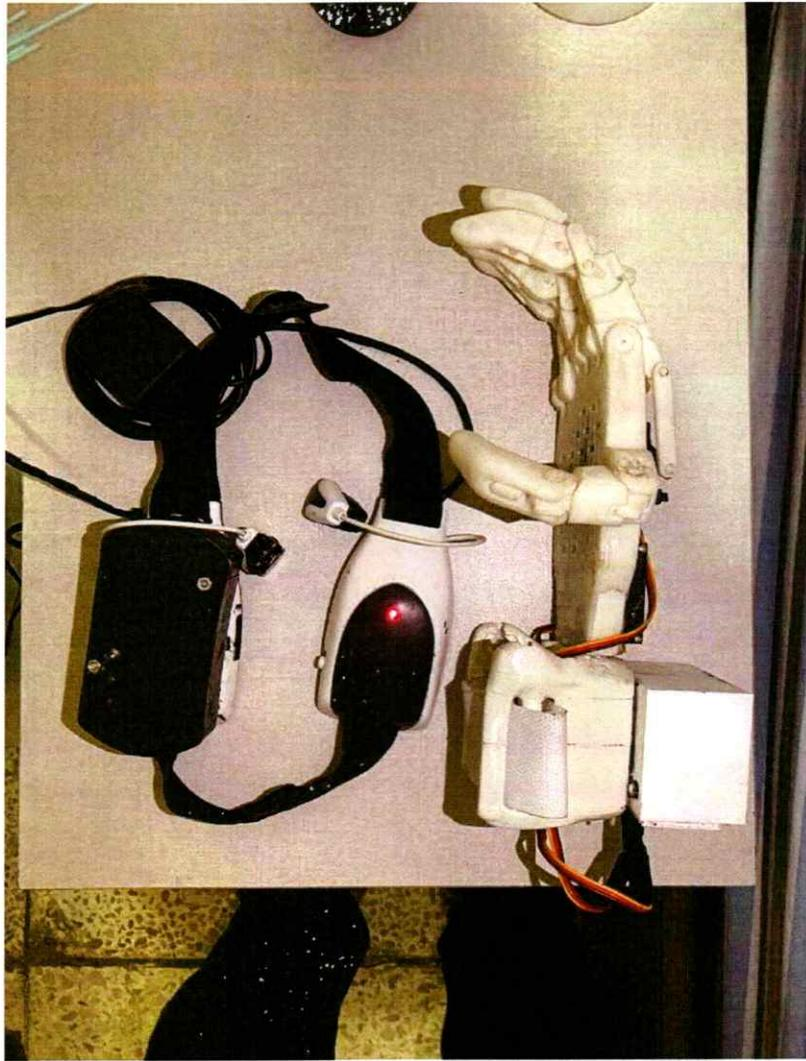
Figura 15. Diseño final de Prótesis de mano junto con Mindflex hackeado. Fuente: Los Autores.
