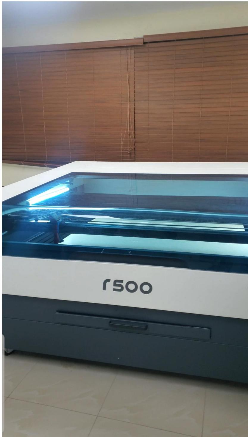
Figura 34. Cortadora láser del prototipo en MDF, por Autores
