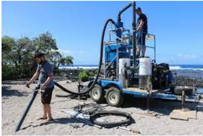
Figura 5. Aspiradoras de arena para la limpieza [21].
