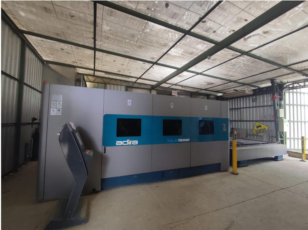
Figura 35. Cortadora láser del prototipo en metal, por Autores
