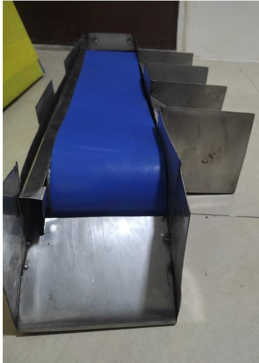
Figura 75. Ensamblaje de la banda. Fuente: Los Autores
