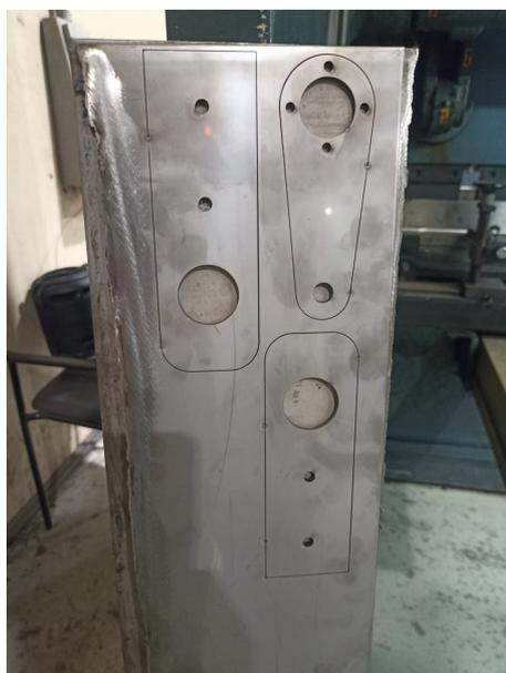
Figura 26. Grabado de diseños en plancha de acero, por J. Jetacama y Y. Guaman.
