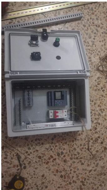
Figura 32. Alineación de componentes en el gabinete, por J. Jetacama y Y. Guaman.
