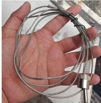
Figura 21. Termocupla tipo k 1mtr. Elaborado por autores.
