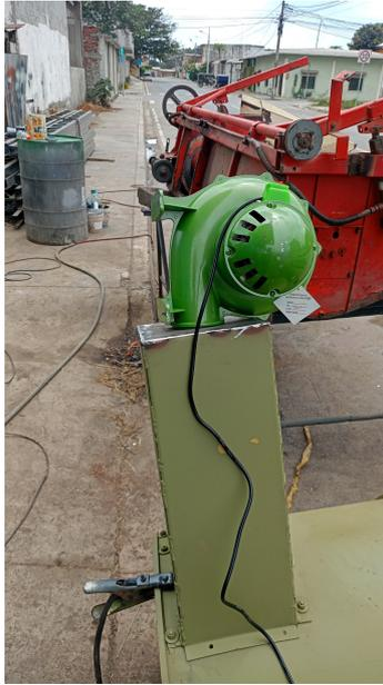
Figura 104. Instalación de blower. Elaborado por autores.
