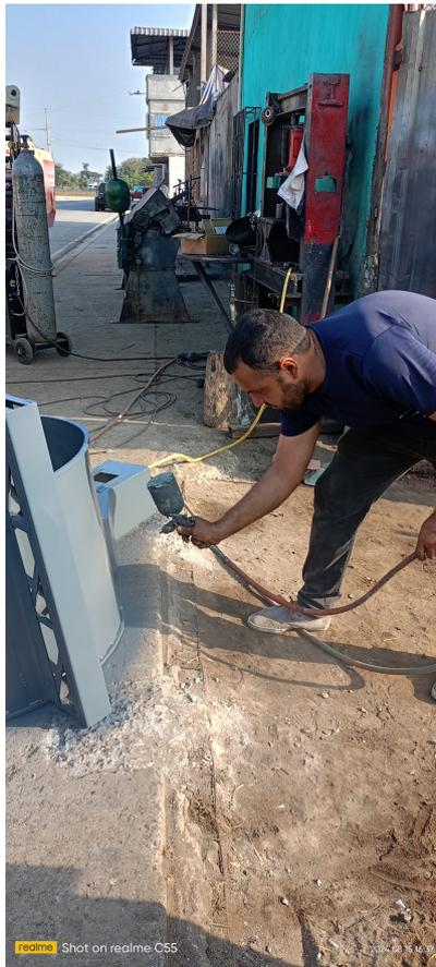
Figura 115. Pintada final máquina parte b. Elaborado por autores.
