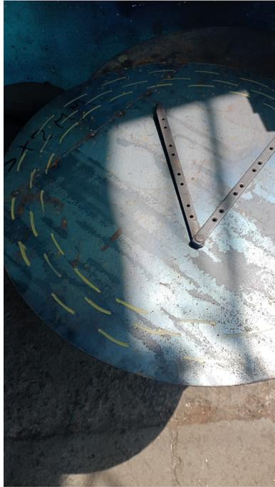
Figura 82. Dimensionamiento de los huecos en el tamiz. Elaborado por autores.
