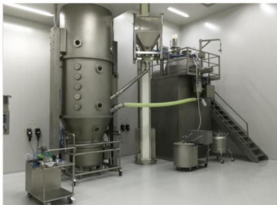
Figura 6. Secador mediante lecho fluido [15].
