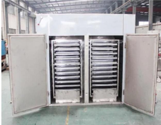
Figura 4. Secador tipo bandeja de flujo en paralelo [17].
