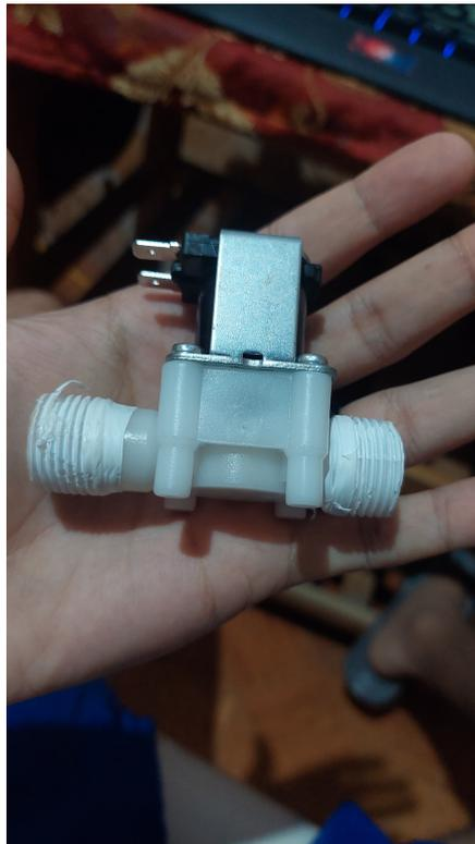
Figura 19. Válvula Solenoide. Elaborado por autores.
