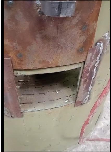
Figura 80. Montaje de la puerta a la olla. Elaborado por autores.
