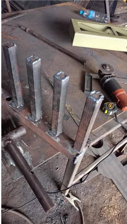
Figura 90. Construcción de paletas parte a. Elaborado por autores.
