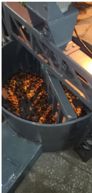
Figura 31. Secado de cacao automatizado. Elaborado por autores.
