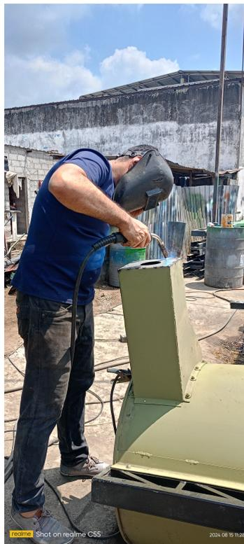
Figura 103. Soldadura en uniones de ducto. Elaborado por autores.
