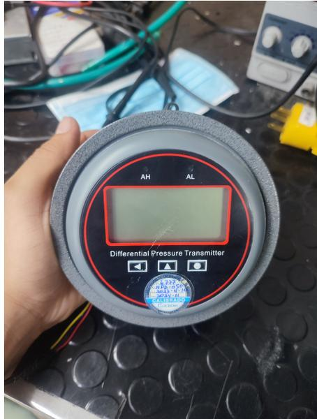
Figura 20. Medidor de presión diferencial digital, por L. Ramírez y J. Castro.
