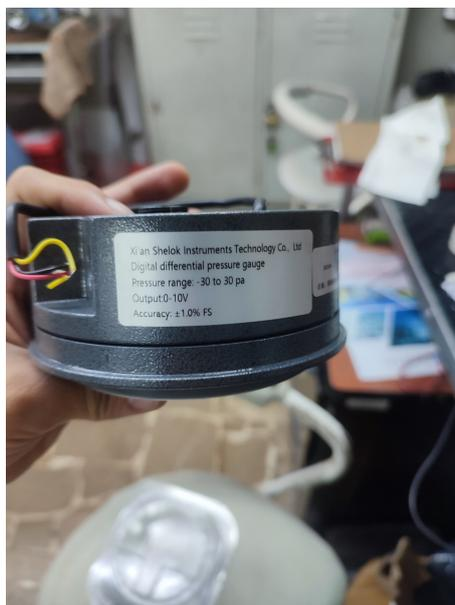
Figura 22. Especificaciones de medidor de presión diferencial, por L. Ramírez y J. Castro.
