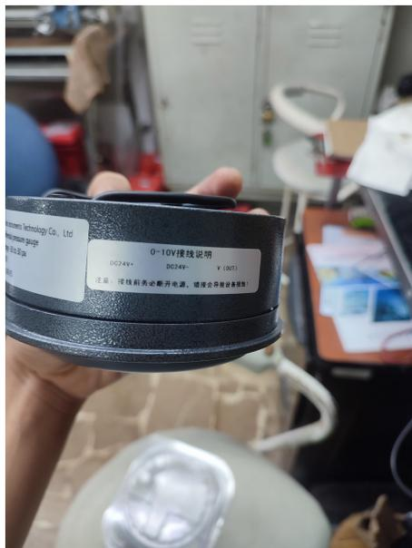
Figura 21. Entrada de alimentación de medidor de presión diferencial, por L. Ramírez y J. Castro
