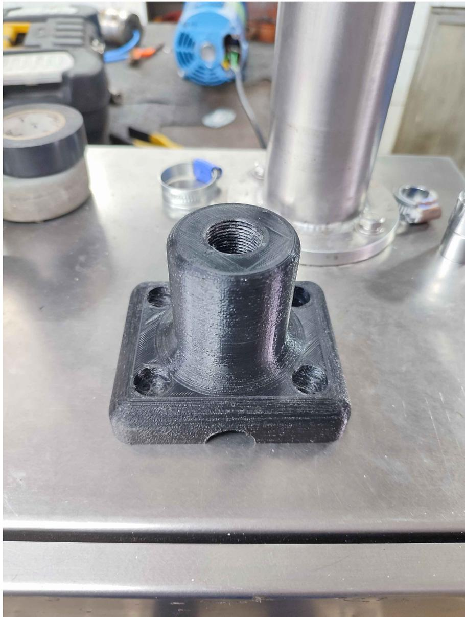
Figura 42. Soporte para baliza impreso, por L. Ramírez y J. Castro, impresión 3D.
