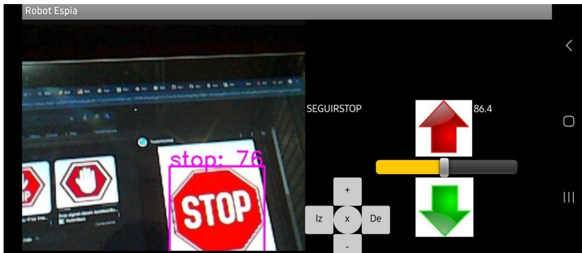
Figura 53. Detección de Señal STOP, por E. Barba
