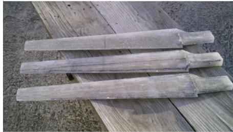
Figura 4. Aspas material de Fibra de Vidrio. *Fuente: Autor.*
