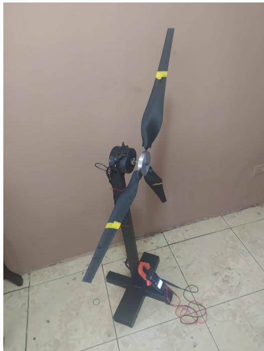
Figura 52. Pruebas de aspas Fibra de Carbono.
