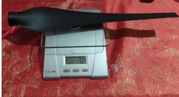
Figura 38. Peso de aspas de Fibra de Carbono. Fuente: Autor.
