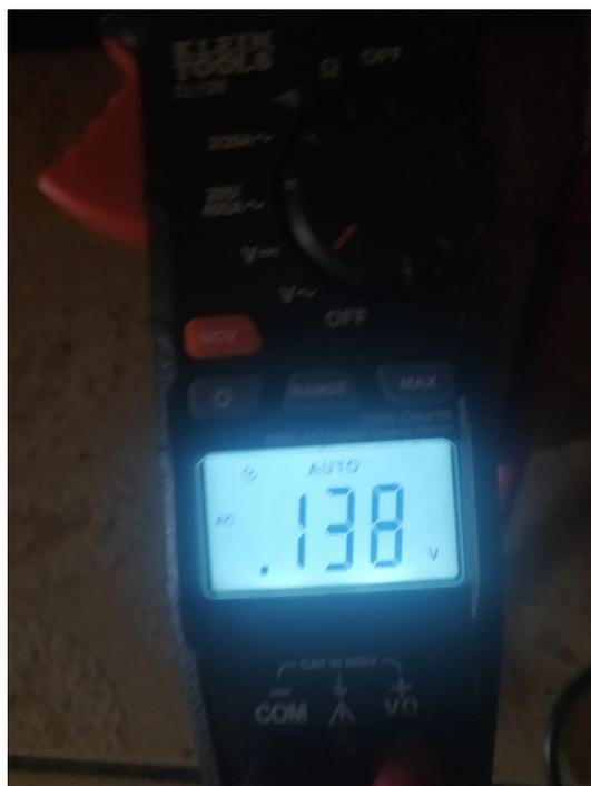
Figura 43. Voltaje que genero el aspas de Fibra de Carbono. Fuente: Autor.
