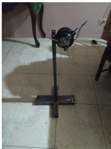
Figura 10. Soporte metálico del generador eólico. Fuente: Autor.
