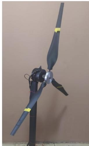
Figura 5. Aspas material Fibra de Carbono. *Fuente: Autor.*
