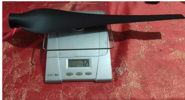
Figura 41. Peso de aspas de Fibra de Carbono. *Fuente: Autor.*
