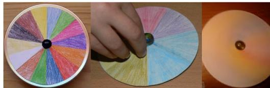
Figura 10. Disco de Newton a baja velocidad, mediana velocidad y alta velocidad [26].
