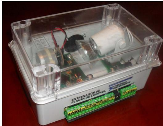
Figura 1. Entrenador de planta de control de National Instruments [6].
