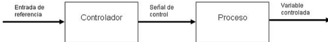
Figura 7. Diagrama de bloques de un modelo de control por lazo abierto [20].
