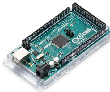
Figura 3. Tarjeta Arduino MEGA 2560 [11].
