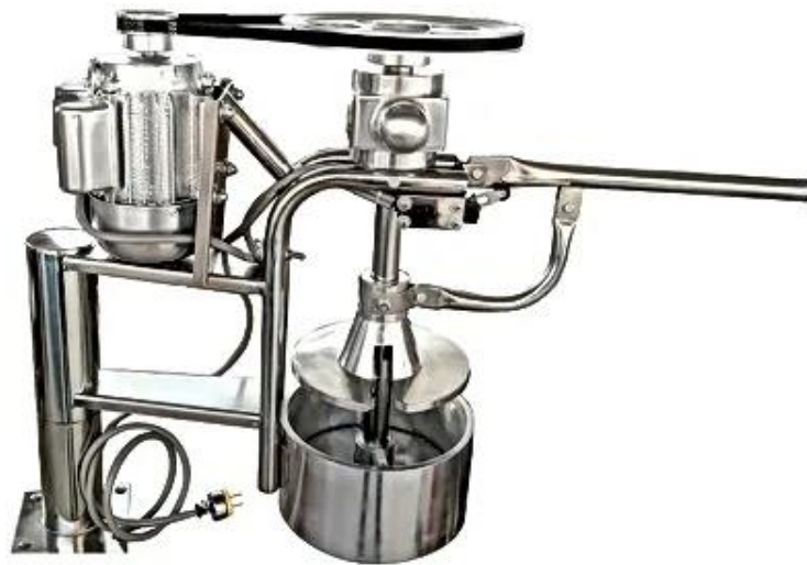
Figura 15. Funcionamiento de cortadora vertical
