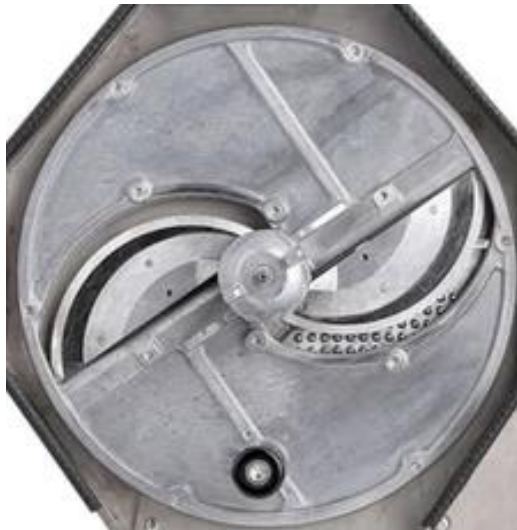
Figura 8. Cuchilla de acero inoxidable [11].
