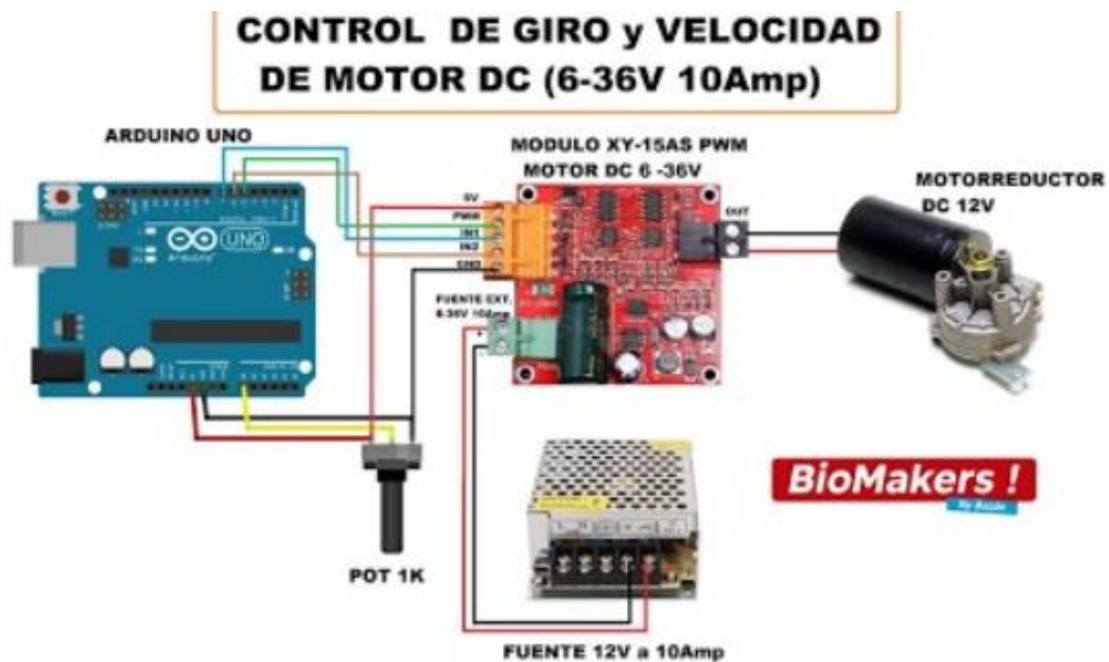
Figura 11. Esquema de conexión del Módulo [21].
