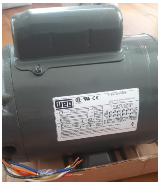
Figura 19. Parámetros del motor WEG
