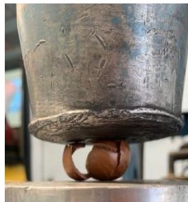
Figura 16. Prensa hidráulica actuando en la nuez de macadamia.
