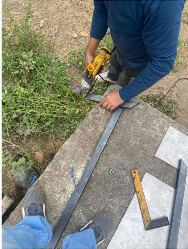
Figura 115. Corte de tubos para la base de la mesa. Fuente: Autores
