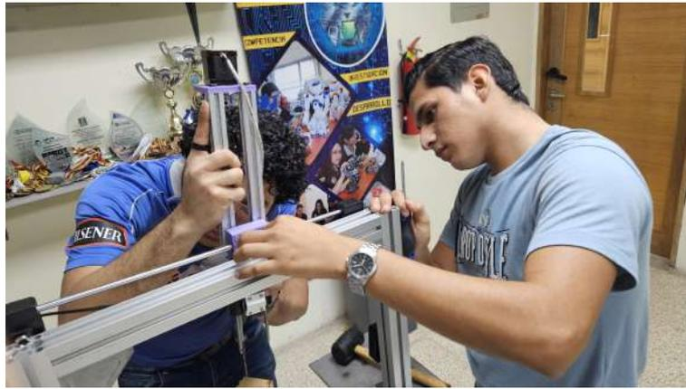
Figura 118. Montaje del eje Z, Fuente: autores.
