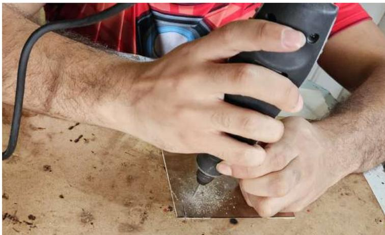
Figura 75. Perforación de agujeros para los componentes electrónicos. Fuente: Autores
