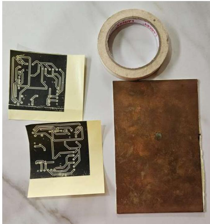
Figura 70. Diseño de pistas del PCB. Fuente: Autores
