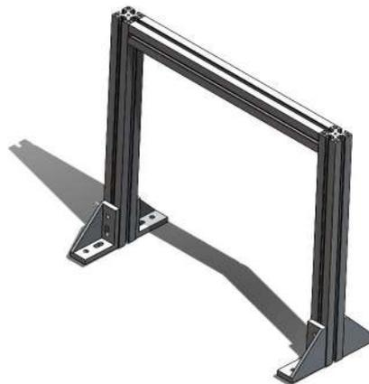
Figura 34. [Marco referencial para la sujeción de los ejes]. Fuente: Autores
