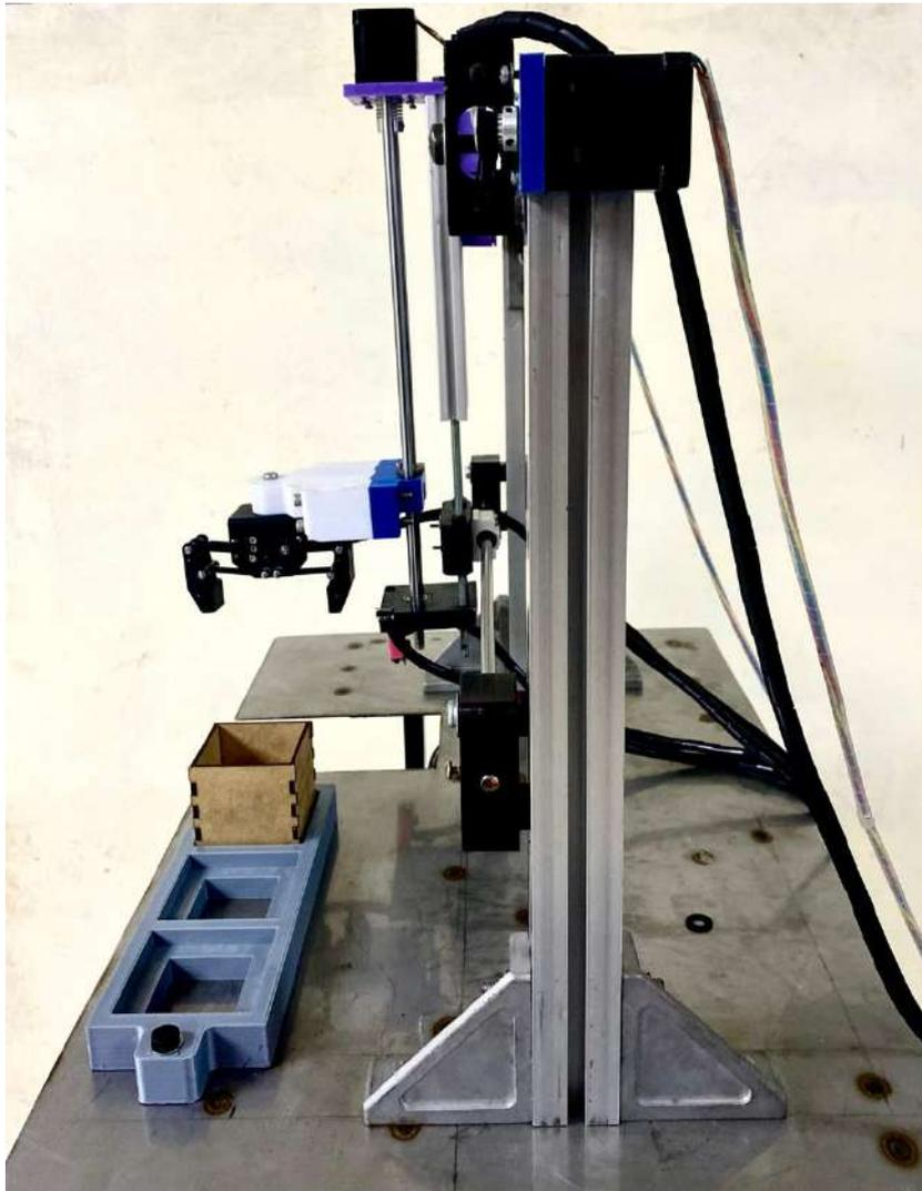
Figura 61. Vista Lateral de los ejes "X", "Z" del pick and place. Fuente: Autores
