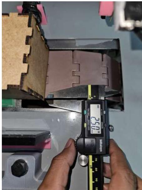
Figura 100. Medición con calibrador digital del desfase de las cajas. Fuente: Autores
