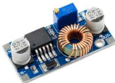
Figura 28. Modulo Step Down [46].
