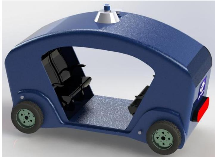
Nota. En la siguiente figura se muestra el tercer prototipo diseñado. Tomado de (Calle & Renteria, 2024).
