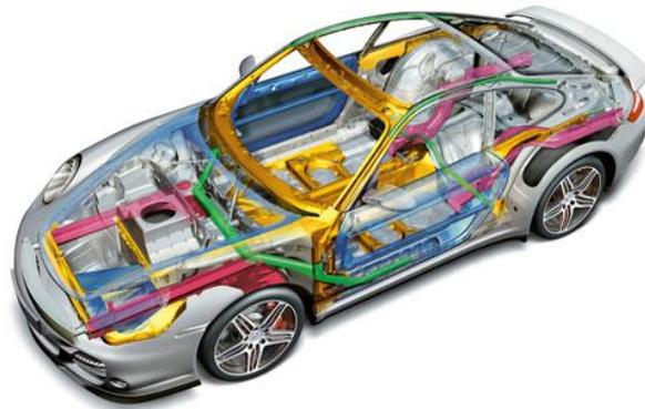
Nota: En la siguiente imagen se muestra una carrocería autóportante. Tomado de (Disprodat, 2018)
