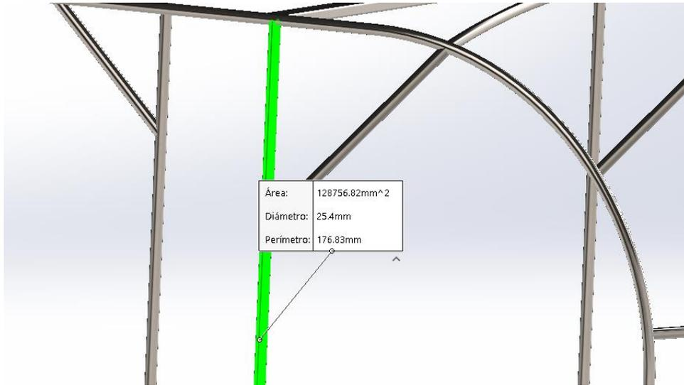
Nota. En la siguiente imagen se muestra el diámetro del tubo. Realizado en SolidWorks por (Calle & Renteria, 2024)
