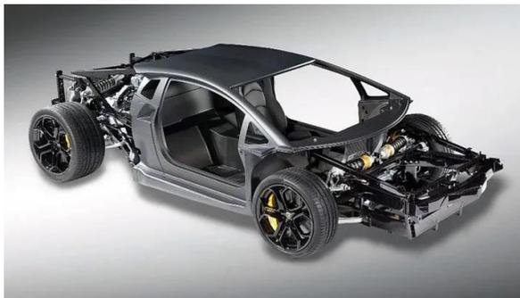
Nota. En la siguiente figura se muestra un chasis tipo Monocasco USLAB. Tomado de (Urquia, 2017)
