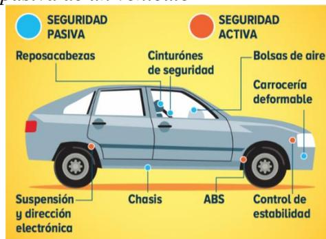
Nota. Esta figura se muestran componentes sobre la seguridad activa y pasiva de un vehículo.
