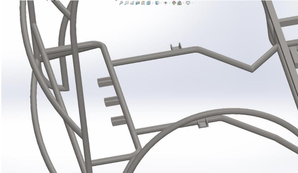
Nota. En la siguiente imagen se muestra la vista de los puntos de anclaje de la estructura en SolidWorks (Calle & Renteria, 2024)
