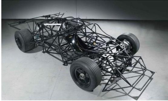
Nota. En la siguiente figura se muestra un chasis Tubular. Tomado de (Urquia, 2017)
