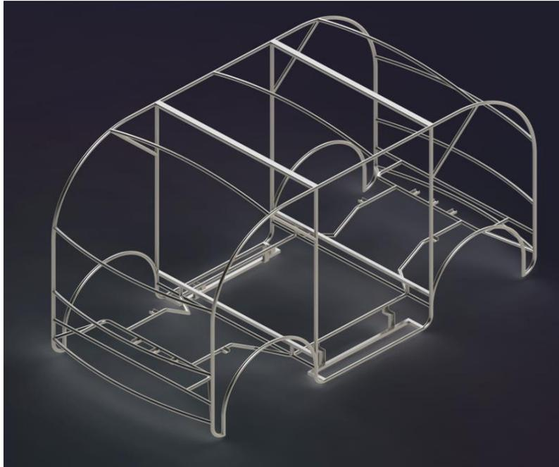
Nota. En la siguiente imagen se muestra la estructura tubular interna de la carrocería en SolidWorks". Realizado por (Calle & Renteria, 2024)
