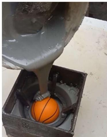
**Figura 16** Vaciado de la mezcla de resina de poliuretano.
