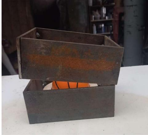
**Figura 15.** Cuerpo superior e inferior del molde en acero P20
