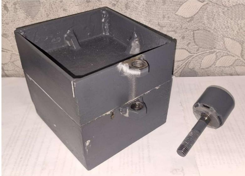
**Figura 18.** Molde de resina con acoples finales.
