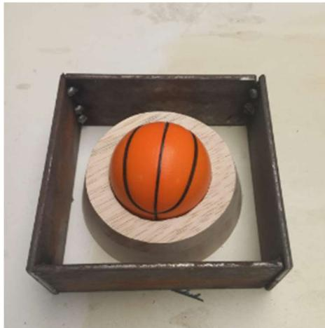
**Figura 14.** Caja de acero P20 y base de madera del producto
