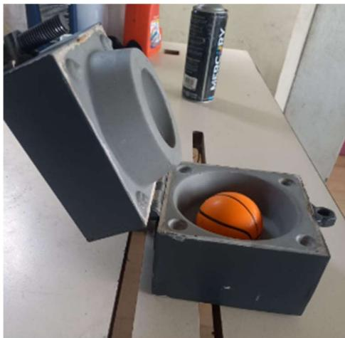
**Figura 20.** Vista lateral de la fabricación de un molde de resina.
