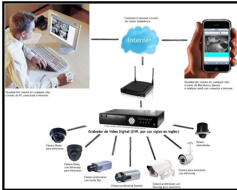
Figura 5: Equipos de CCTV
