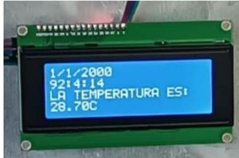
Nota. Display LCD 20X4 (Tecnikro, 2024)
