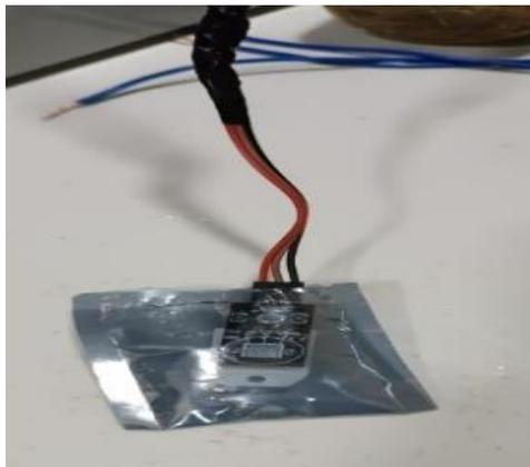
Nota. El sensor DHT22 censa la temperatura ambiente del invernadero (SigmaElectrónica, 2024)
