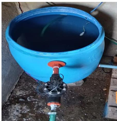
Nota. El sensor de nivel de agua detecta el tanque está vacío o lleno.
