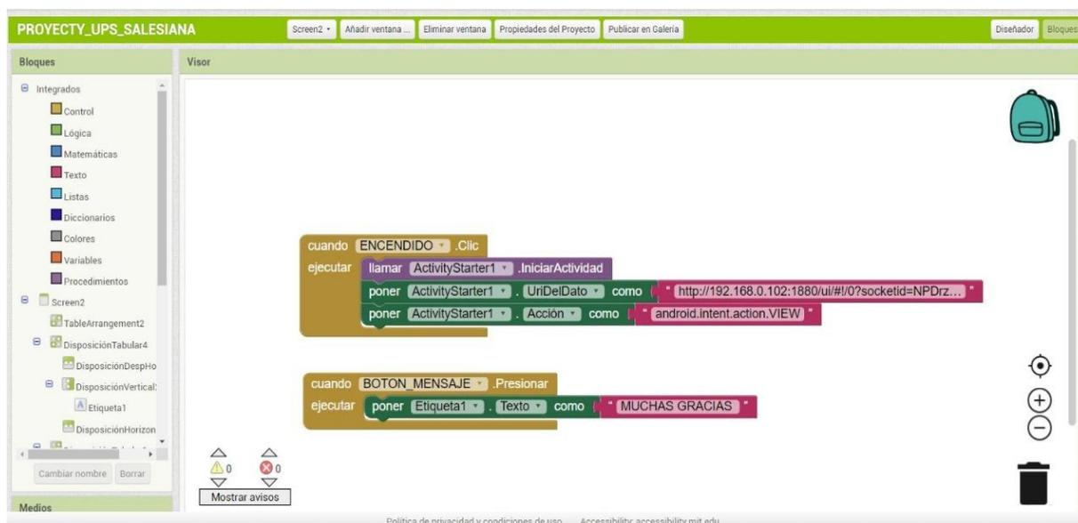
Nota. En la figura se muestra la activación del botón de encendido y el ingreso de la IP.
