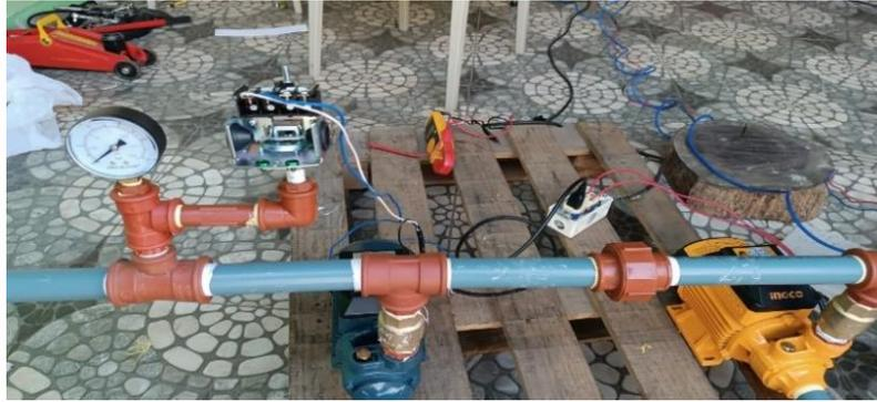
Nota. El sistema de tubería de descarga se encarga de controlar el flujo hasta la bomba y el sistema de distribución regulando la presión.
