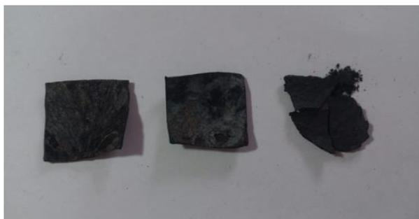
**Figura 15.** Carbonización de las cascaras de coco a 450\_°C
