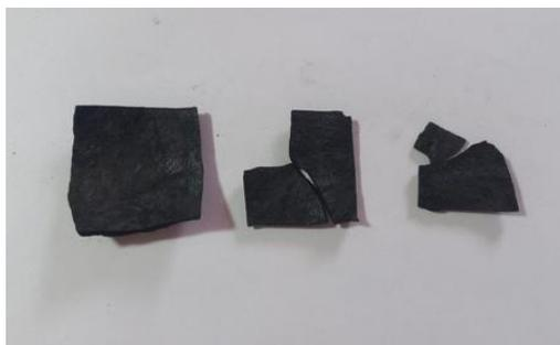
**Figura 14.** Carbonización de las cascaras de coco a 350\_°C
