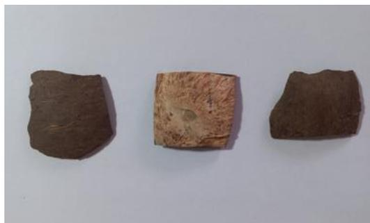
**Figura 13.** Carbonización de las cascaras de coco a 250\_°C
