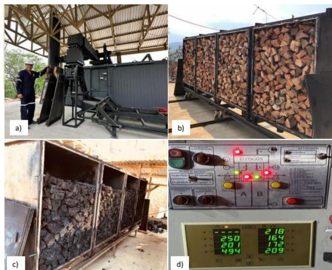
**Figura 5.** Hornos de metal, a) horno EKKO2 con tecnología refractaria, b) cámara de secado cargada con madera, c) cámara de secado después de la pirólisis, c) tablero de control.
