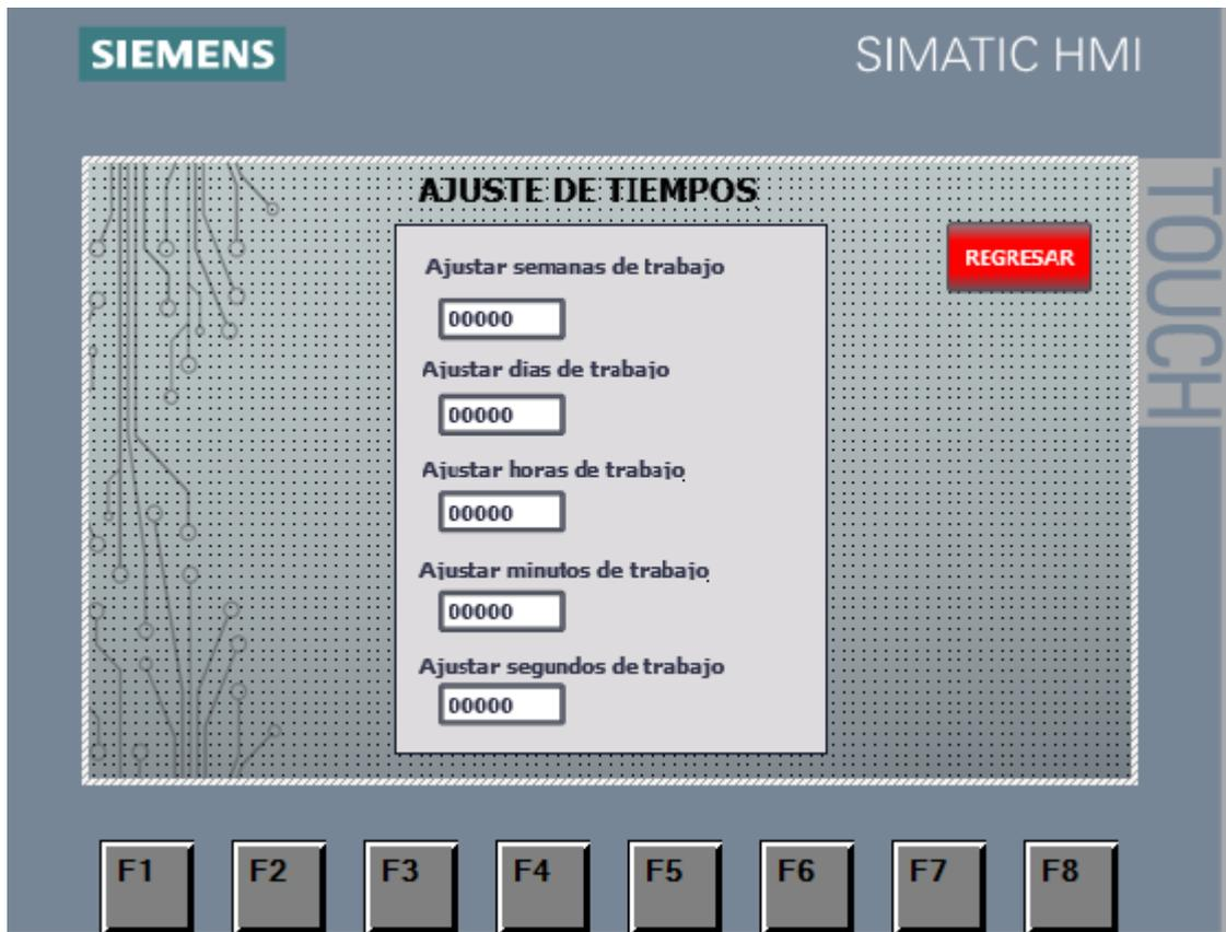
Nota. Ingreso del tiempo de la simulación del biodigestor.
