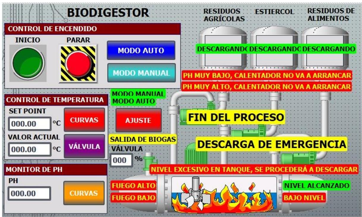
Nota. Diseño de la pantalla principal del HMI.
