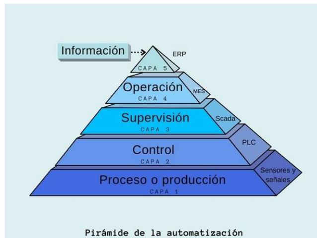
**Nota.** Representación de un sistema de automatización (ITDG, s.f.).
