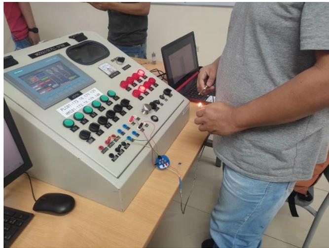
Nota. Variacion de temperatura mediante la entrada analogica utilizando una termocupla tipo K.
