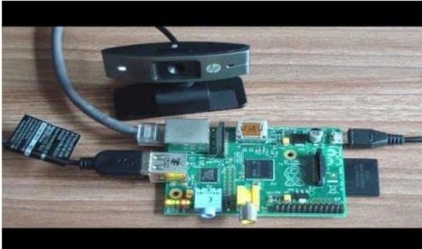
**Figura 17.** Cámara web con Raspberry Pi (GEOVANNY, 2019).
