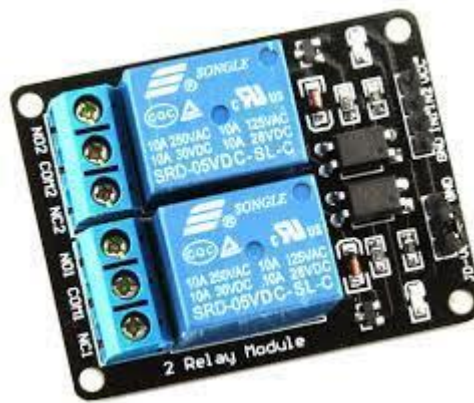
Figura 11. Relay de 2 Canales Luces Pilotos. (hobbytronica, 2022)
