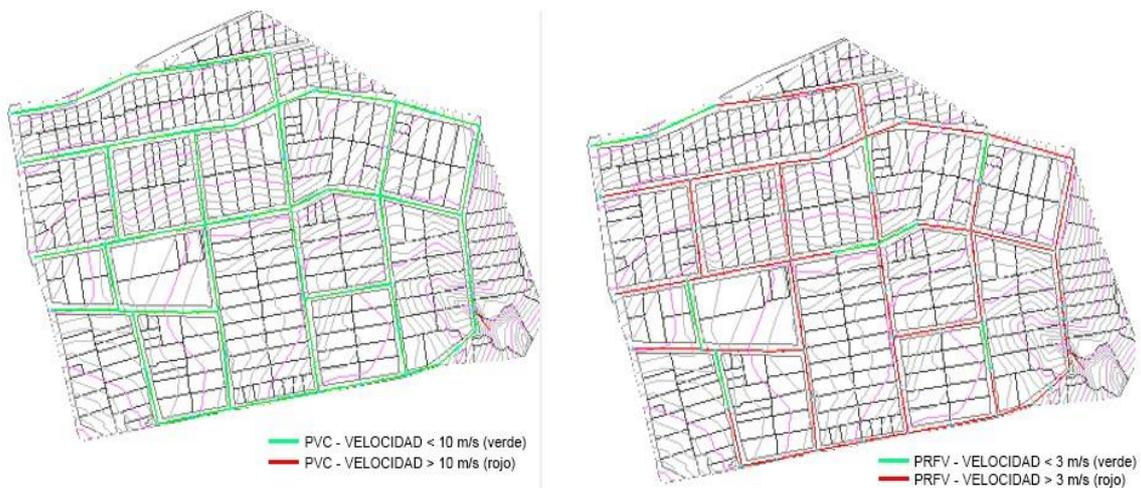
*Nota: Gráfico de la izquierda PVC, velocidad de 10m/s y derecha 3m/s de PRFV. Elaborado por: Los autores, a través de SewerGems.*
