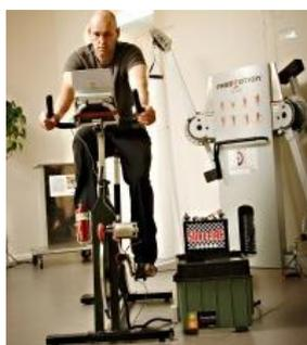
Figura 2.1: Generación de energía mediante el uso de bicicletas<sup>5</sup>
