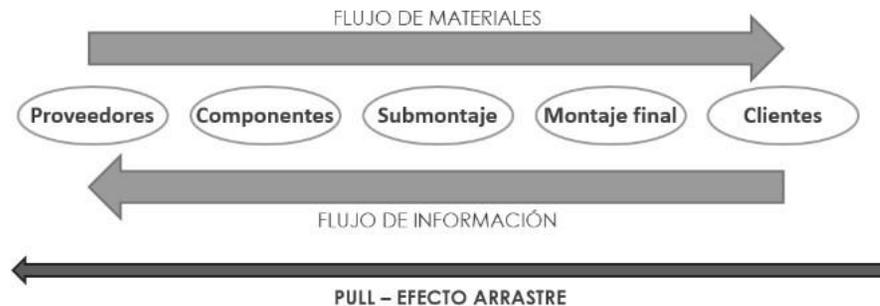
**Figura 7.** Sistema de control de producción tipo Pull, [15].
