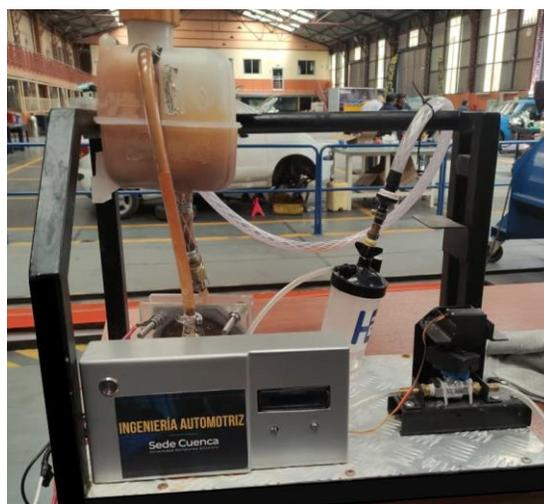
Nota. El generador tiene alimentaciones de energía de 12v lo cual se puede conectar a la motocicleta para su funcionamiento tanto para el generador de hidrógeno como para la electroválvula para la apertura de este. Fuente: imagen del generador de hidrógeno de la tesis de (TOROCHE CRIOLLO & AGILA MACAS, 2023)
