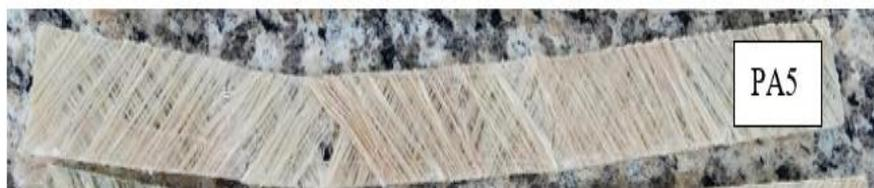
*Nota:* Fractura de la probeta PA5, luego del ensayo de tracción. Fuente: Autores.
