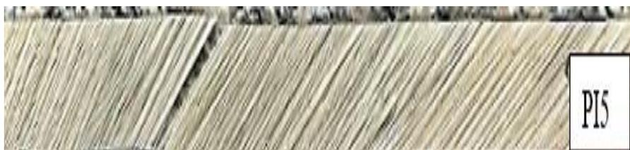
*Nota:* Fractura de la probeta PI5, luego del ensayo de tracción. Fuente: Autores.
