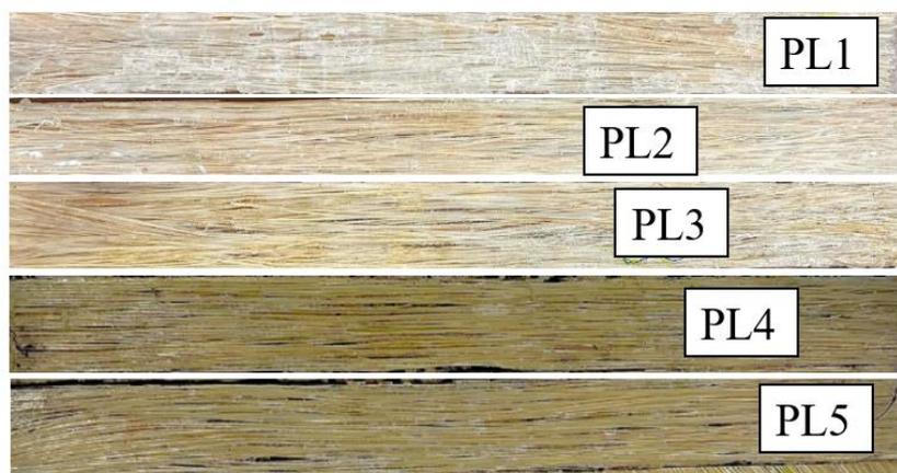
Nota: *Probetas longitudinales de fibra de abacá. Fuente: Autores.*
