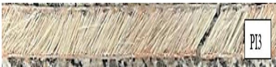
*Nota:* Fractura de la probeta PI3, luego del ensayo de tracción. Fuente: Autores
