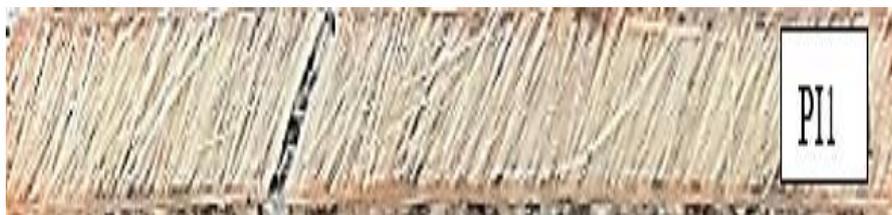
*Nota:* Fractura de la probeta PI1, luego del ensayo de tracción. Fuente: Autores.
