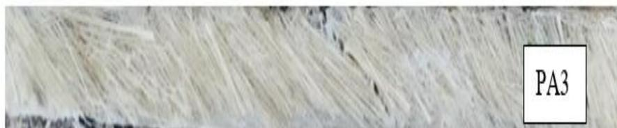
*Nota:* Fractura de la probeta PA3, luego del ensayo de tracción. Fuente: Autores.
