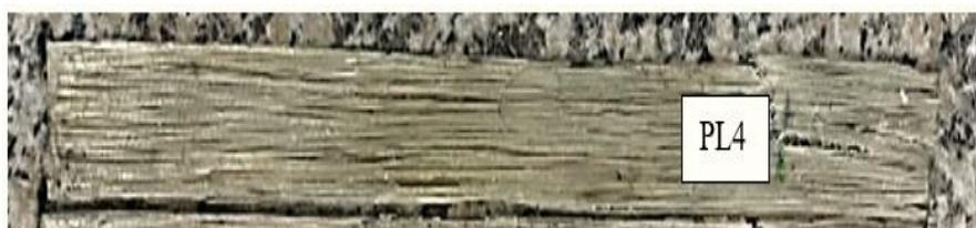
*Nota:* Fractura de la probeta PL4, luego del ensayo de tracción. Fuente: Autores.
