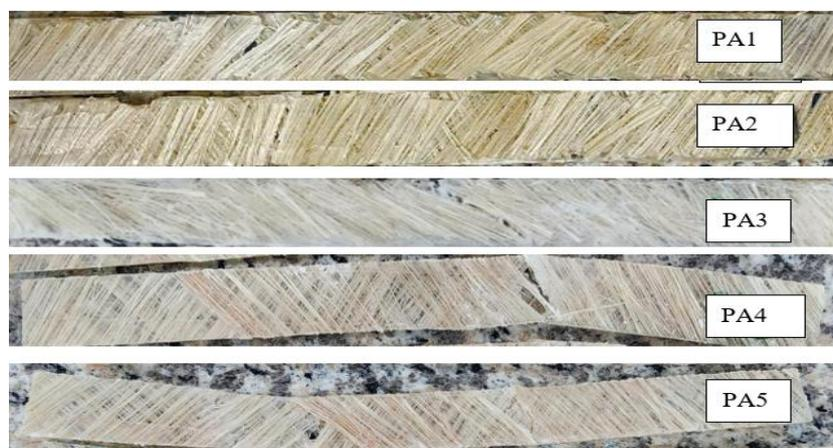
*Nota:* Probeta fracturadas luego de la realización de los ensayos de tracción. Fuente: Autores.
