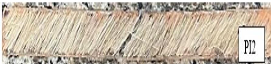
*Nota:* Fractura de la probeta PI2, luego del ensayo de tracción. Fuente: Autores.
