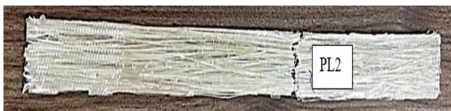
*Nota:* Fractura de la probeta PL2, luego del ensayo de tracción. Fuente: Autores.
