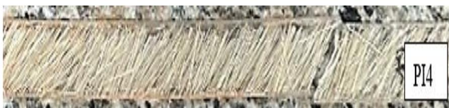
*Nota:* Fractura de la probeta PI4, luego del ensayo de tracción. Fuente: Autores.
