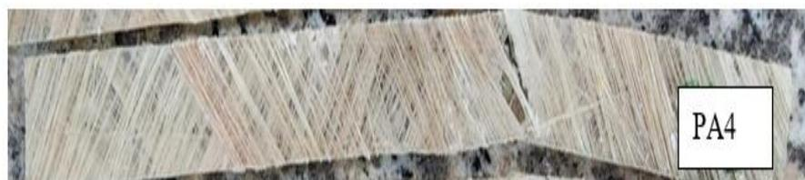
*Nota:* Fractura de la probeta PA4, luego del ensayo de tracción. Fuente: Autores.
