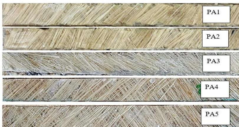
*Nota:* Probetas con orientación aleatoria de fibra de abacá. Fuente: Autores.
