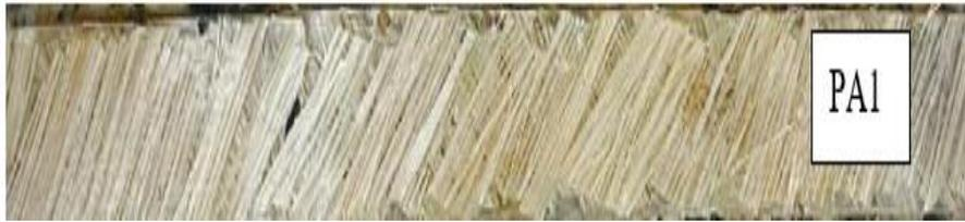
*Nota:* Fractura de la probeta PA1, luego del ensayo de tracción. Fuente: Autores.
