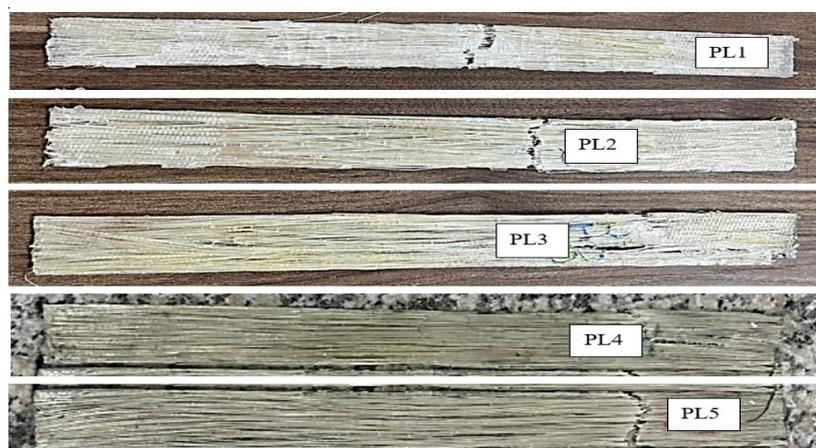
*Nota: Probeta fracturadas luego de la realización de los ensayos de tracción. Fuente:*
