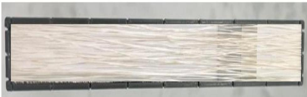
*Nota:* Proceso de secado de probeta fabricada con resina epoxi y fibra de Abacá. Fuente: Autores.
