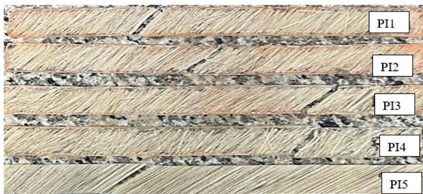
*Nota:* Probeta fracturadas luego de la realización de los ensayos de tracción. Fuente: Autores.
