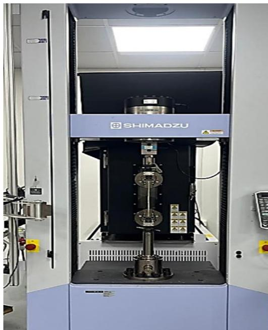
*Nota:* Los ensayos de tracción se realizaron en la máquina universal Shimadzu AGS-X 300 kN. Fuente: Autores.
