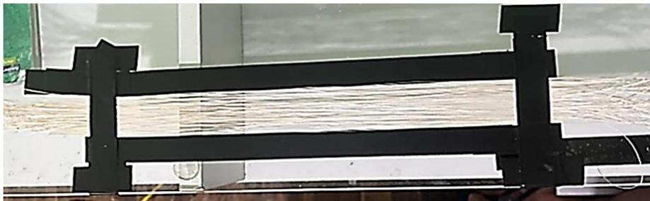
*Nota:* Se colocó las fibras de Abacá de manera longitudinal en el espacio dimensionado.
