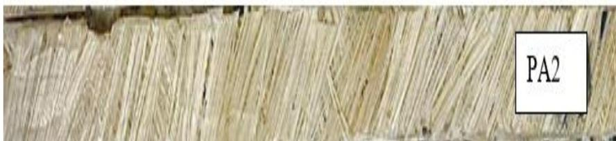
*Nota:* Fractura de la probeta PA2, luego del ensayo de tracción. Fuente: Autores.
