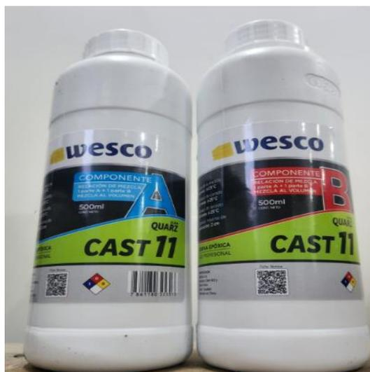
*Nota:* Resina Epoxi, compuesto químico polimérico empleado en la fabricación de las probetas. Fuente: Autores.
