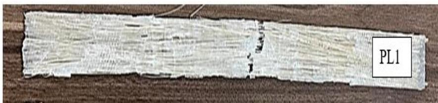
*Nota:* Fractura de la probeta PL1, luego del ensayo de tracción. Fuente: Autores.
