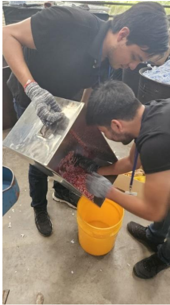
Figura 62. Extracción del material triturado.
