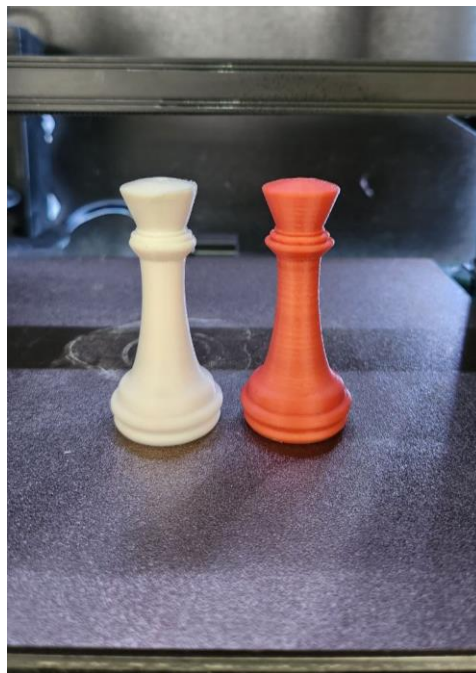
Figura 70. Comparación de impresiones por extrusión directa.
