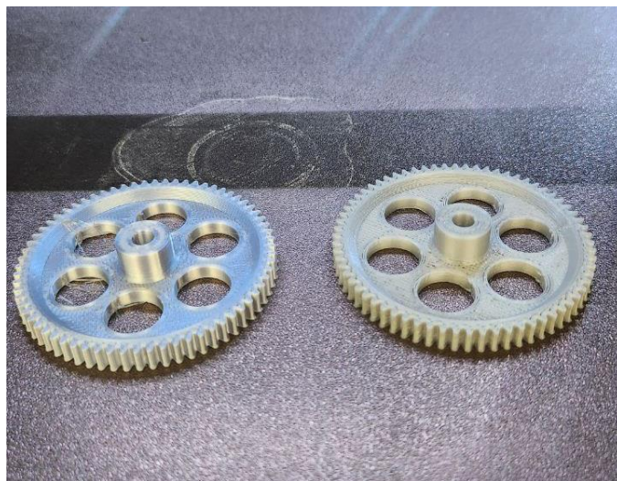
Figura 72. Comparación de impresiones por sistema bowden.
