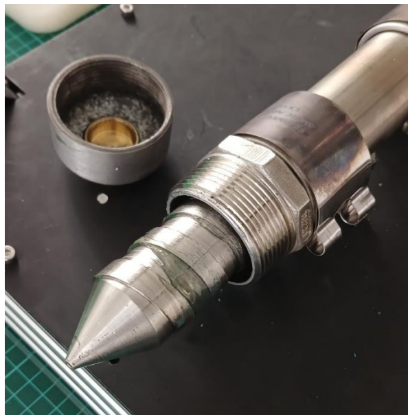
Figura 54. Tornillo sin fin acoplado en el cañón de extrusión.
