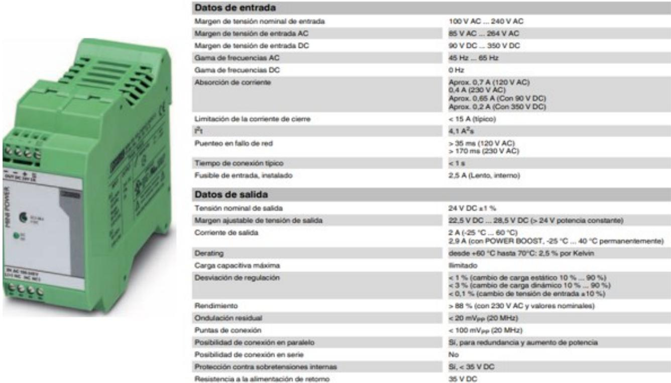
Figura 4 Phoenix Contact Mini-PS y su especificación técnica (Phoenix Contact, 2020)
