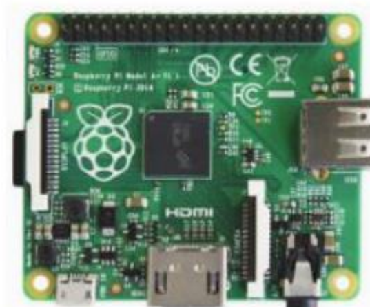
Figuras 6 Raspberry Pi 1 modelo A+
