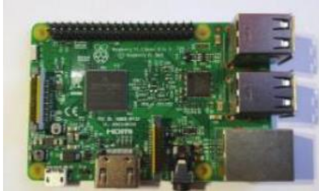
Figuras 7 Raspberry Pi 3 modelo B
