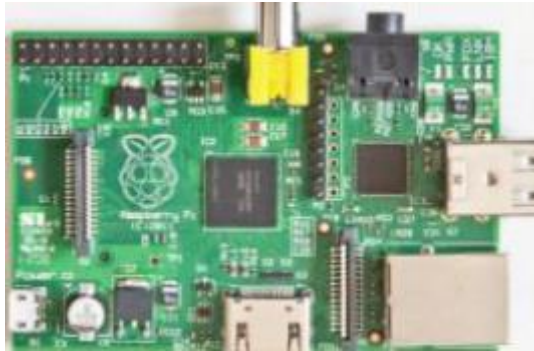
Figuras 3 Raspberry Pi 1 modelo B
