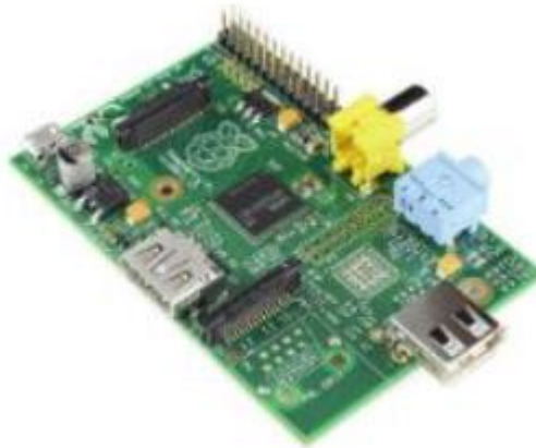
Figuras 4 Raspberry Pi 1 modelo A
