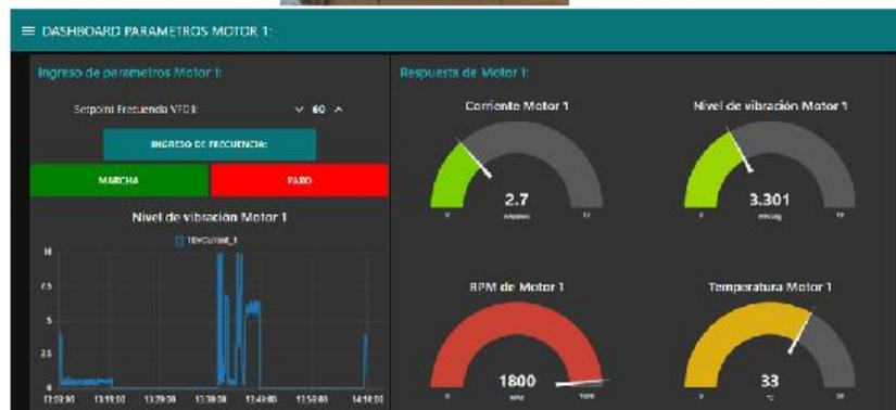
Nota: Figura muestra el comportamiento de las señales entregadas por el prototipo (nuestra Planta)
