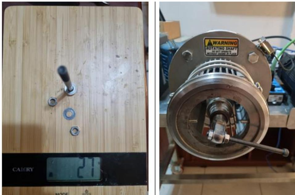
*Nota: Carga de 27 gramos instalado con el fin de generar un desbalanceo en el eje del motor*
