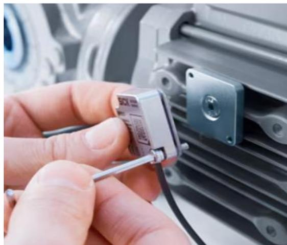
*Nota: sensor marca SICK integrado al motor (SICK AG, 2022)*
