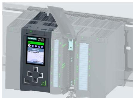
Figura 7 Modelo 3D de la CPU 1516-3PN/DP del laboratorio (SIEMENS, 2014).
