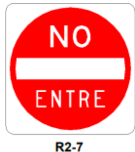
Ilustración 16. Señalización no entre (R2-7)
