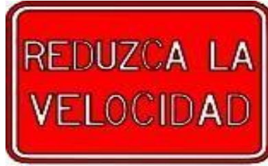
Ilustración 23. Señalización reducir velocidad (R4-4)
