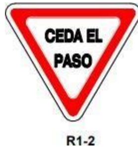
Ilustración 21. Señalización ceda el paso (R1-2)
