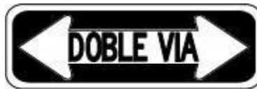
Ilustración 20. Señalización doble vía (R2-2)
