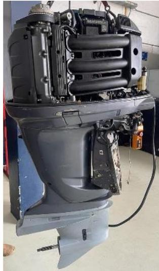
**Fig. 4.** Motor fuera de borda Yamaha 200 HP de 4 tiempos.
