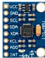
Figura 7. Componente electrónico MPU6050 [25]
