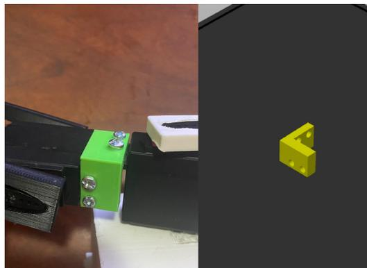
Figura 25. Union de servomotores impresa y en el software PrusaSlicer, por K. Scippa y A. Rosales.
