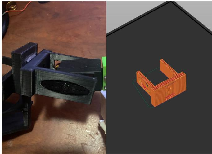
Figura 26. Acople impreso y en el software PrusaSlicer, por K. Scippa y A. Rosales.
