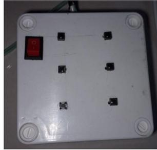
Figura 50: Control del puente grúa
