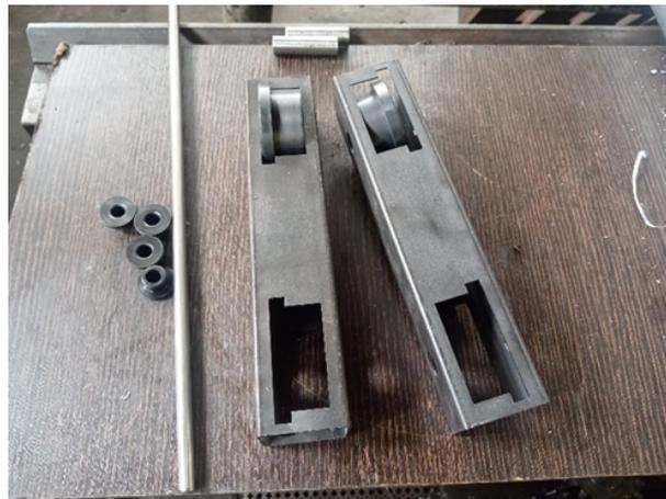
Figura 42. Vigas testeras diseñadas. Fuentes: Los autores
