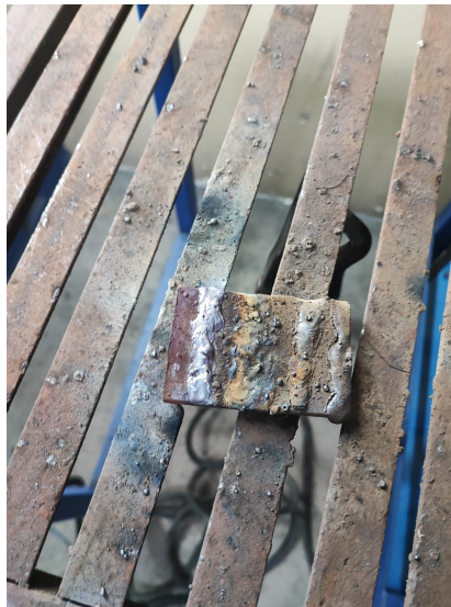
Figura 48. Cordones de soldadura realizado por estudiantes en prácticas
