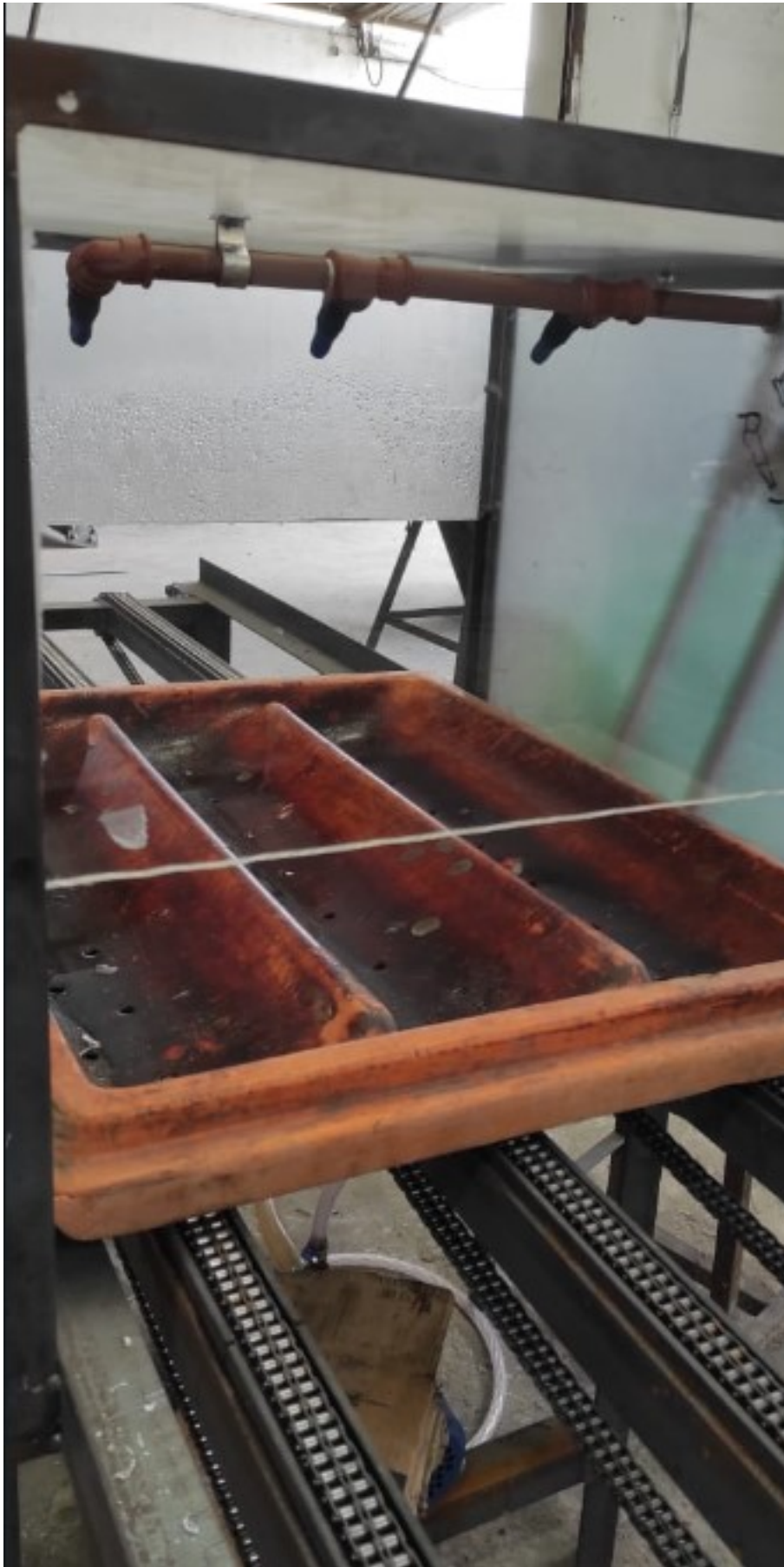
Figura 50. instalación de atomizadores
