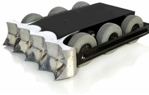
Figura 11. Diseño de robot KillDozer tipo rammer. [30].
