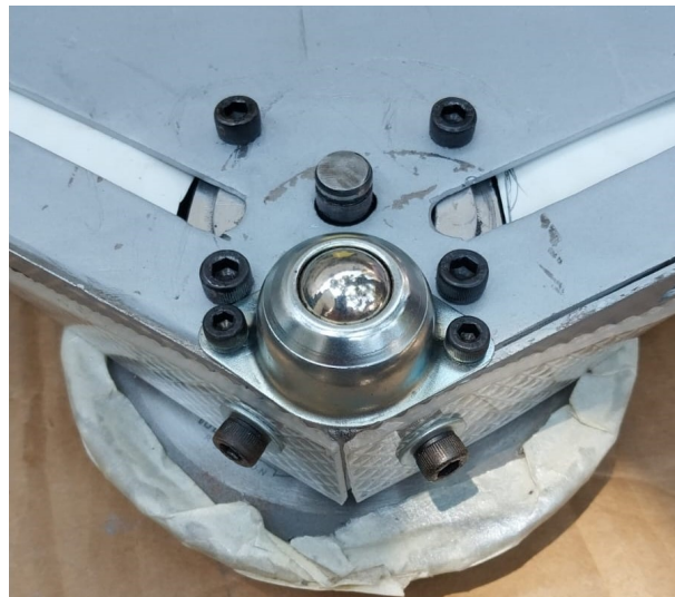
Figura 97. Montaje rueda loca. Fuente: Autores.
