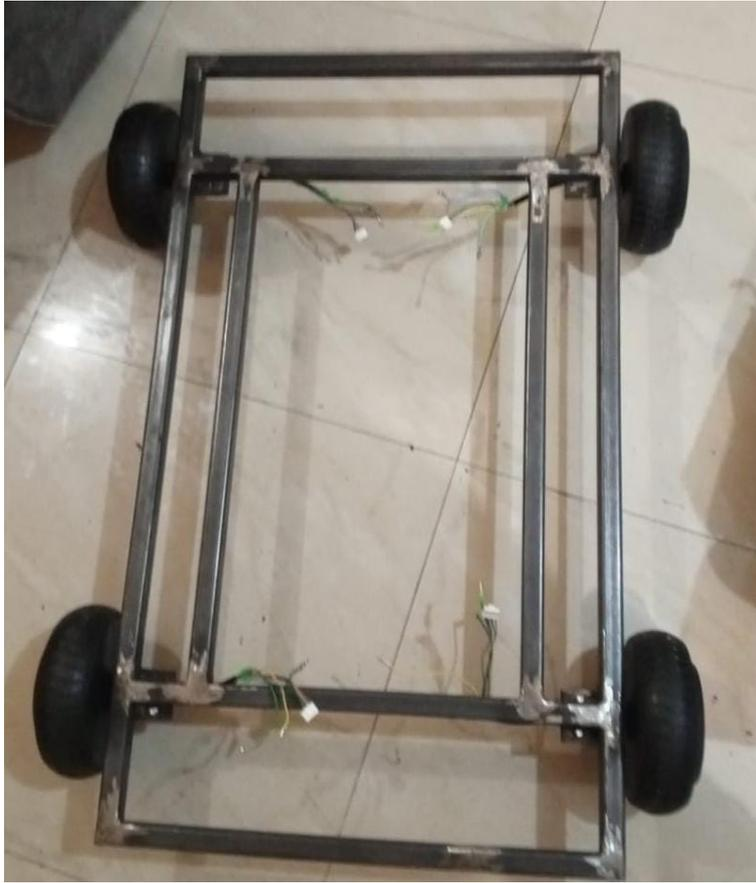
Figura 42. Diseño de la base con las 4 llantas por J. Cadena C.Freire, 2024.
