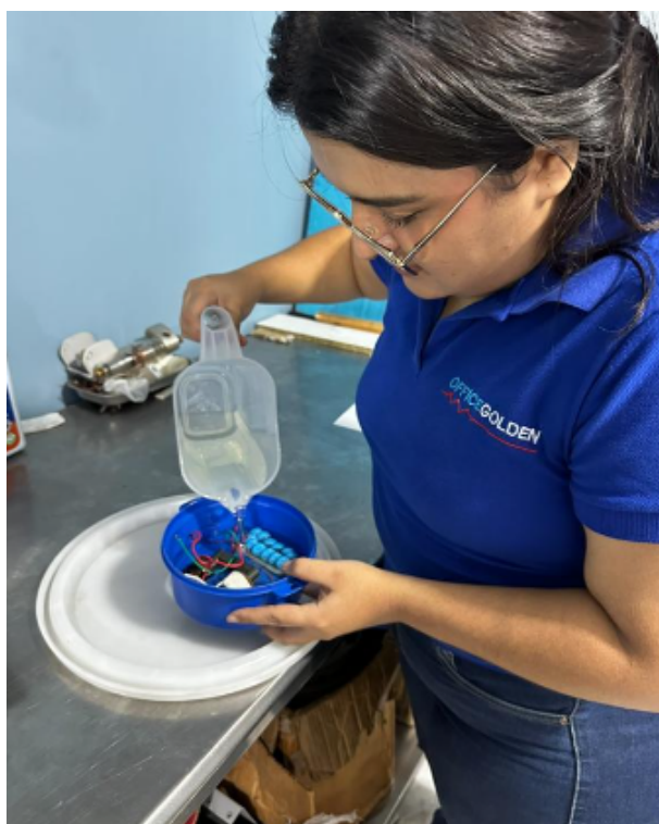
Figura 79. Circuito de alta tensión sumergido en aceite. Fuente: Autor
