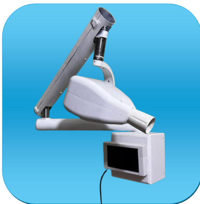
Figura 102. Prototipo de rayos X periapical. Fuente: Autor
