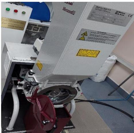
*Figura 12. Molino 15/21 M2.6 PM INSON utilizado para la molienda del PET. Fuente: El autor.*
