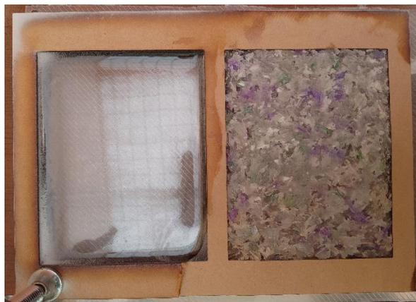
Figura 15. Extracción de probetas. A la izquierda se encuentra la resina pura y a la derecha la resina-PET. Fuente: el autor.
