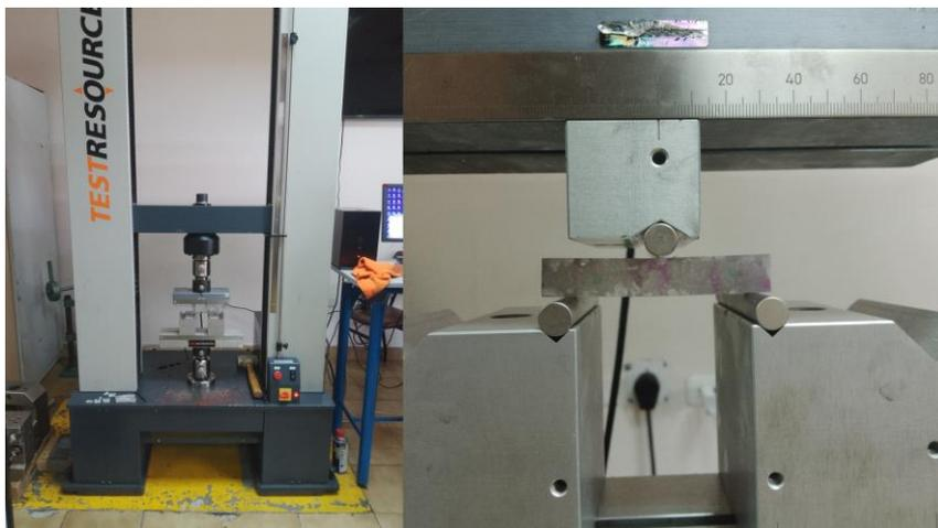
Figura 20. Equipo Universal de ensayos de Flexión Testresources 316-1096 (izq.) y probeta con tres puntos de apoyo y rodillos de 10mm (der.) Fuente: autor.
