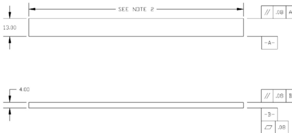
Figura 10. Geometría de la probeta requerida para la norma ASTM D 7264/D 7262M - 07 [41].
