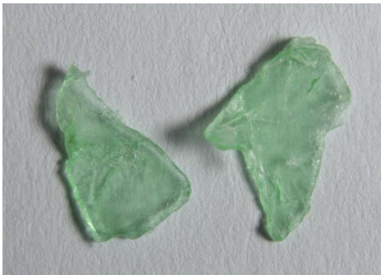
*Figura 13. Escamas de PET triturado donde se evidencia su gran superficie y presencia de rebabas las cuales no están presentes en el PET peletizado. Fuente: el autor.*
