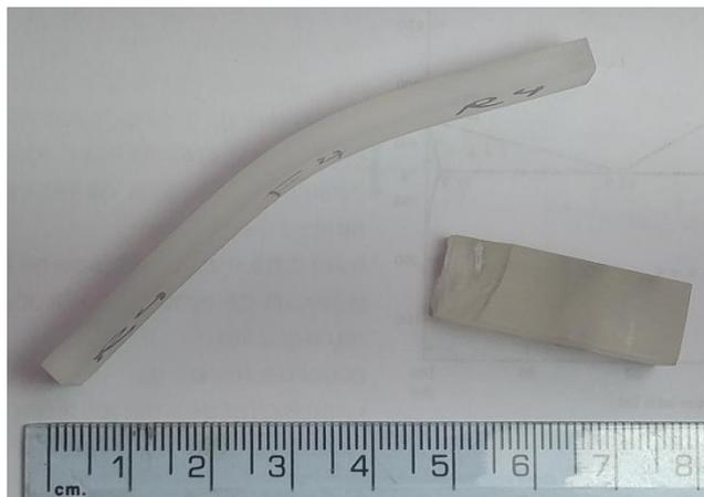
*Figura 21. Probeta de resina pura Dura Quarz Cast-11 (izq.) la cual resulta ser muy flexible y resina Q2 (der.) la cual resulta ser quebradiza.*
