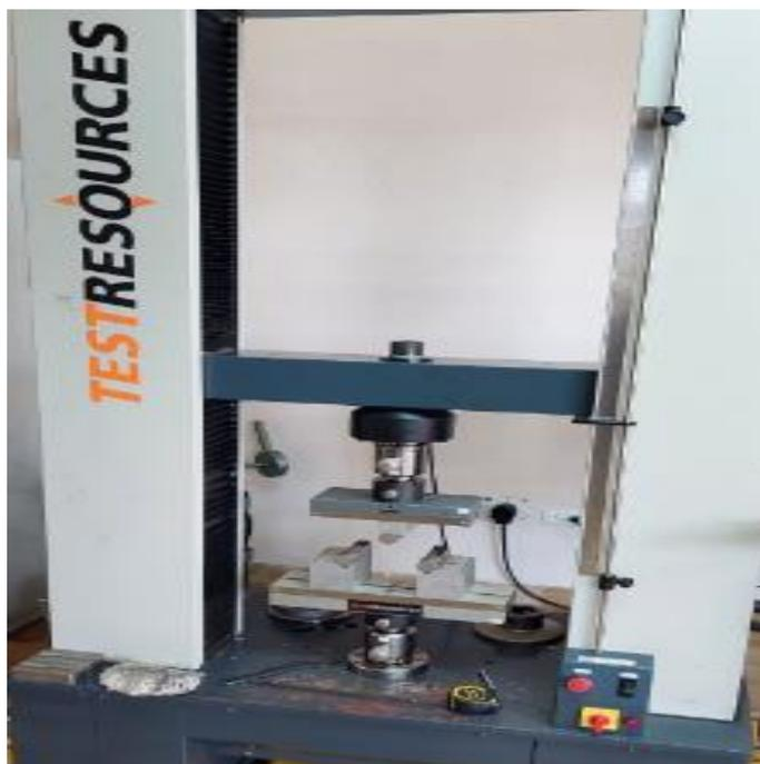
*Figura 11. Máquina de flexión Testresources modelo 316-1096.*
