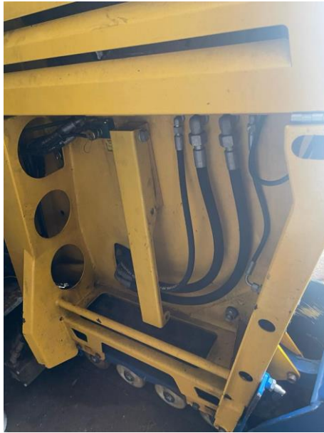
Figura 51. Vista de las mangueras hidráulicas de la Volteadora
