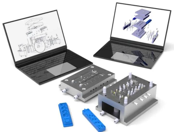
**Nota:** En la Figura se observa prototipos para el diseño de moldes así como el uso de software especializados de ingeniería, de acuerdo a Engineering (2021).
