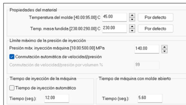
**Nota:** En la Figura se muestra las propiedades del material seleccionado junto con los parámetros configurados.
