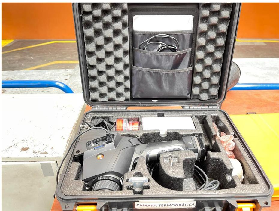
*Nota: Cámara termográfica a utilizar durante la adquisición de temperaturas de funcionamiento del catalizador. Fuente: Autores.*
