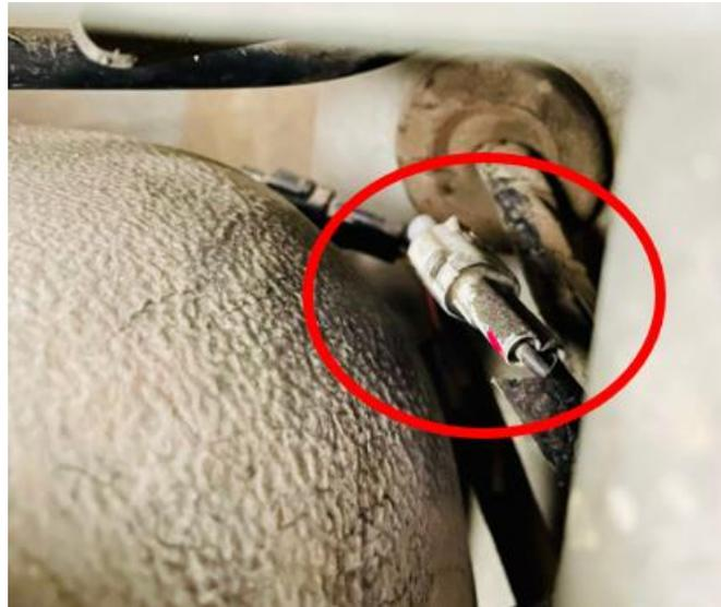
Nota: *Desconexión del Socket de bomba de combustible del vehículo. Fuente: Autores*
