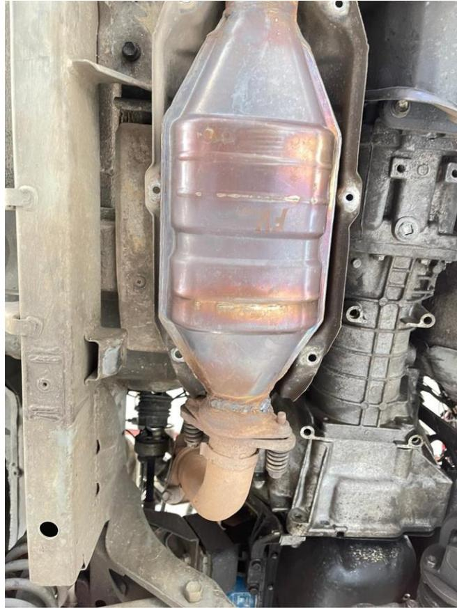
*Nota: Superficie real del catalizador lista para realizar pruebas termográficas. Fuente: Autores.*
