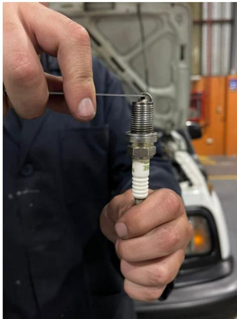
*Nota: Calibración de bujías usando un gauge en milímetros. Fuente: Autores.*
