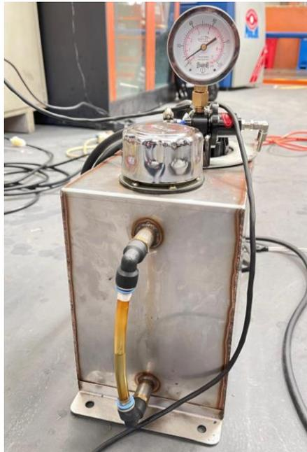
*Nota: Para las pruebas se requiere de un tanque externo para suministrar las mezclas de combustible-etanol. Fuente: Autores.*
