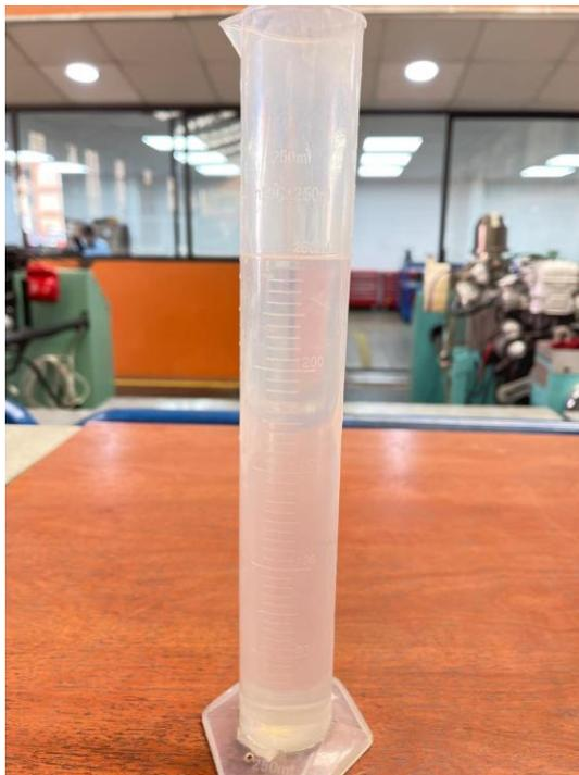
*Nota: Probeta de laboratorio para medición de etanol y combustible eco país para realizar las mezclas correctas.*
