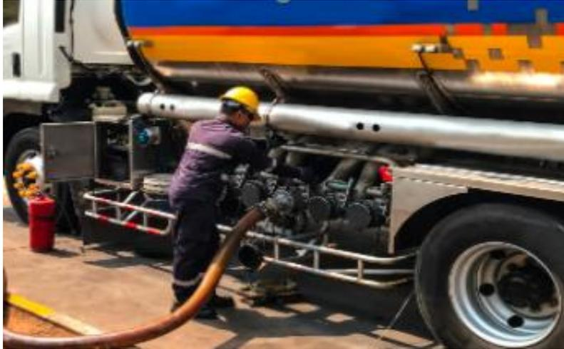
**Figura 5.** Bombas utilizadas para la transferencia de combustible.
