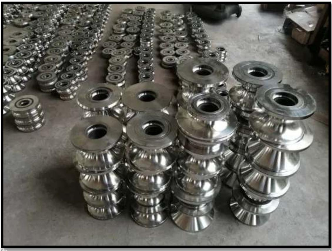
*Ilustración 6 – Rodillos de deformación de acero*
