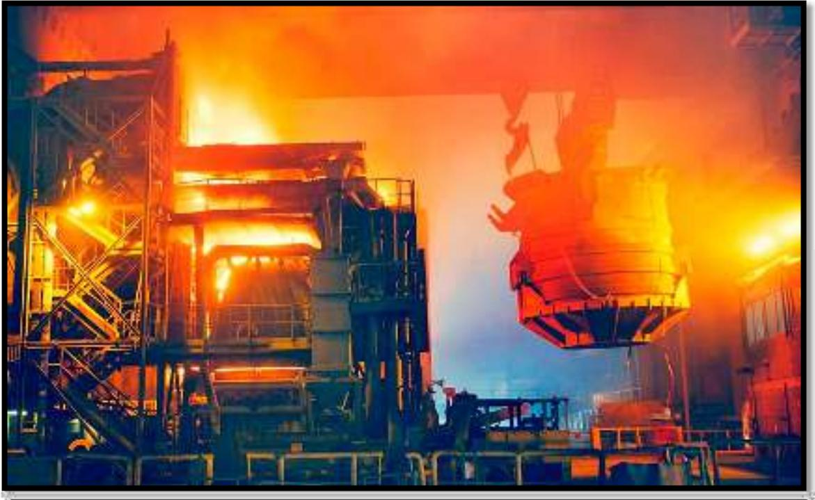
*Ilustración 12 Transporte de acero a colada continua*
