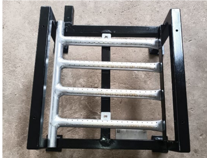
Figura 26. Posicionamiento de flautas sobre base del calentador
