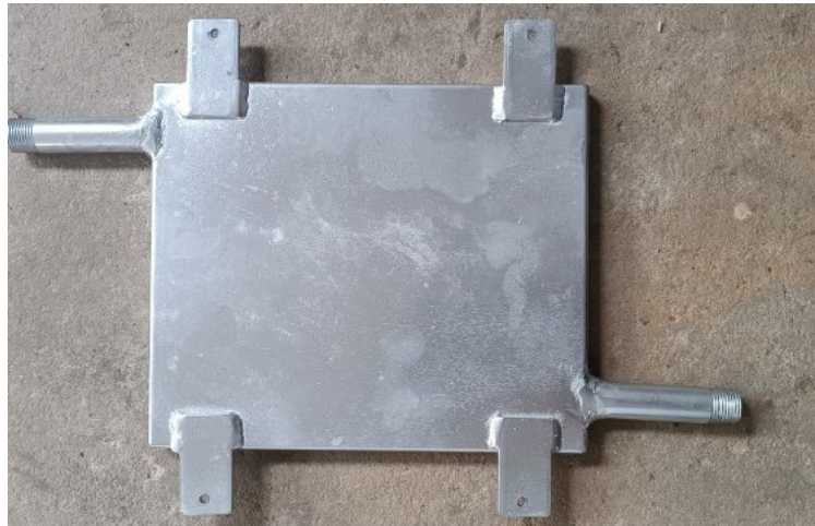
Figura 28. Montaje de placa plana y soporte
