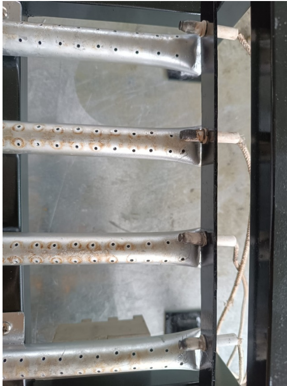
Figura 27. Ubicación de electrodos de encendido
