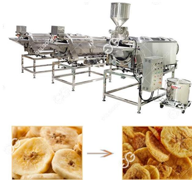
**Figura 19.** Máquina mezcladora continua de condimentos
