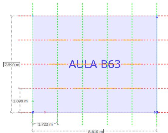
**Figuras 67.** Simulación de luminarias específicas del Aula B63
