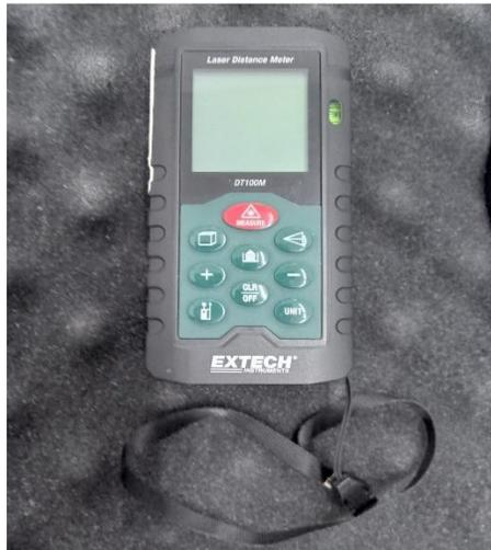
**Figura 15.** Instrumento Distanciómetro
