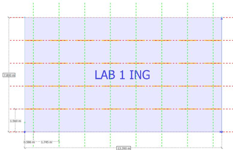
**Figura 51.** Simulación de luminarias específicas del Laboratorio 1
