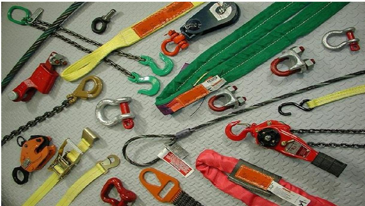
Nota. Las herramientas de izaje son equipos diseñados para levantar y transportar cargas pesadas de manera segura y eficiente, estas pueden ser: eslingas, ganchos, aparejos, entre otros. Tomado de (CS Beaver, 2017).
